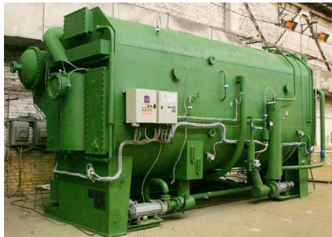
Холодильная машина с паровым обогревом с двухступенчатой регенерацией раствора АБХМ2-3000П мощностью 3000 кВт из поставки на Калининскую атомную электростанцию
